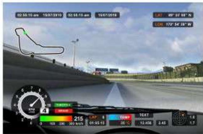
Le vetture sono dotate di un sistema di **video telemetria** (con gps ed accelerometri integrati) che consente la registrazione del video e dei dati associati alla guida: uso di **acceleratore**, **freno**, rilevamento **velocità** e **forza di gravità**, rilevamento del **tempo sul giro**.
